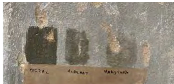
Tests de consolidation avec un hydroxyde de calcium. Communément de 4 à 10 passages sont nécessaires, à 1 % dans un mélange d'isopropanol/eau. Ici, même après 12 passages le fixage n'était pas suffisant sur la zone de test.
