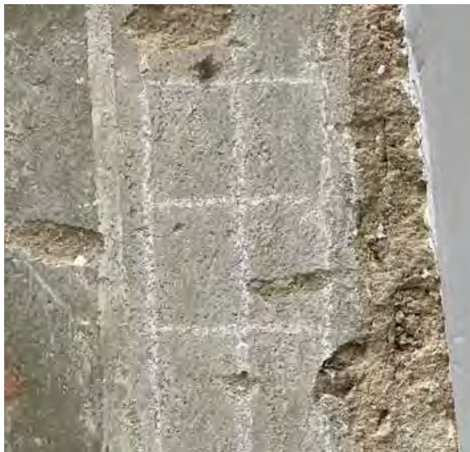
Tests de consolidation avec un hydroxyde de calcium. Communément de 4 à 10 passages sont nécessaires, à 1 % dans un mélange d'isopropanol/eau. Ici, même après 12 passages le fixage n'était pas suffisant sur la zone de test.
