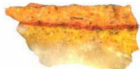
Ecaïlle en coupe, vue optique, échantillon n° S2020-39 A
