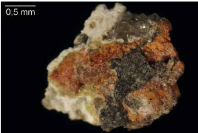
Vue en microscopie stéréoscopique de la face externe de l'échantillon PM3. Grandissement d'origine: x32
