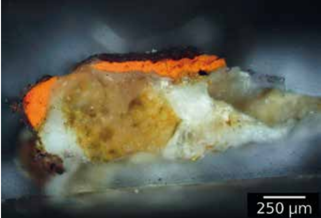
Vue en microscopie épiscopique de la section transversale polie de l'échantillon PM3. Grandissement d'origine: x50.
