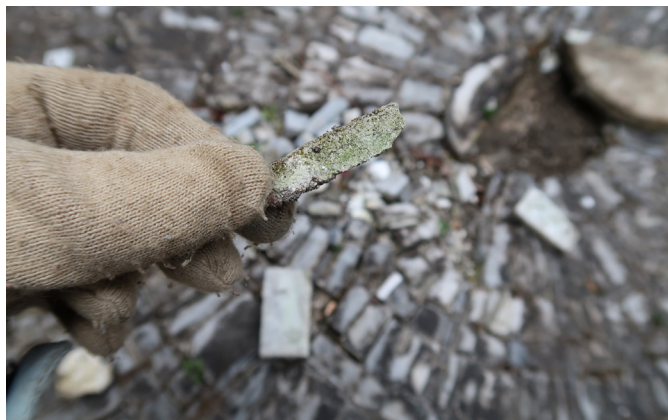
Lacune réintégrée dont les tesselles se détachent, échantillon du mortier de pose blanc
