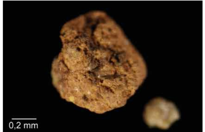
Vue en microscopie stéréoscopique de l'échantillon MDG05. Grandissement d'origine: x64.
